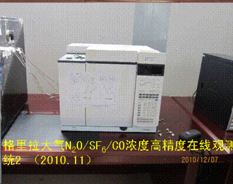
香格里拉大气N 2 O/SF 6 /CO浓度高精度在线观测系统1 (2010.11)
